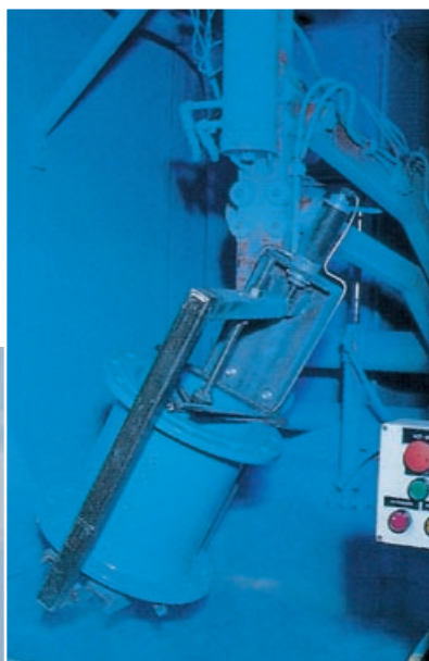
Zdjęcie środkowe: Powlekanie fluidyzacyjne: stapianie proszku epoksydowego przy 200°C
