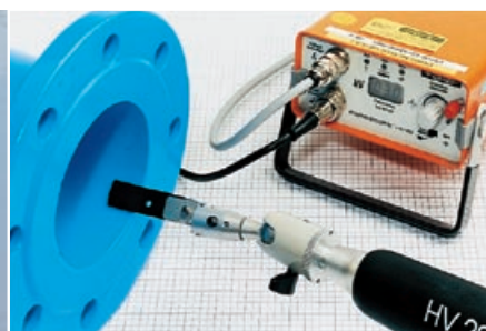
Zdjęcie prawe - górne: Pomiar grubości powłoki: minimum 250 \mu\text{m}
