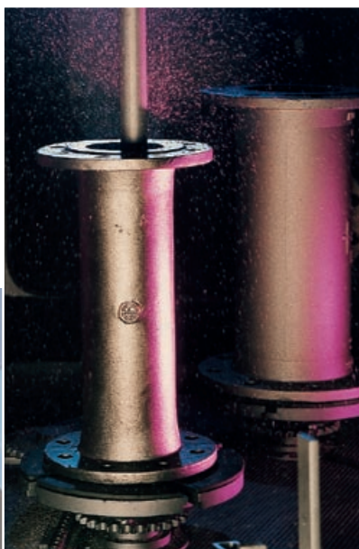
Zdjęcie lewe: Piaskowanie: również wewnątrz kształtek przy użyciu specjalnej lancy
