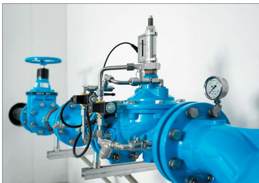
Ilustracja 1. Zawór regulacyjny nr kat. 1795 z indywidualnie sterowanymi zaworami magnetycznymi do sterowania przepływem
